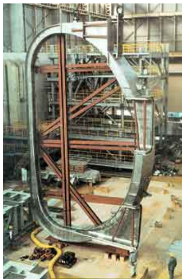
Рис.5 Вакуумная камера в Атомы водорода вводятся в предварительно приобрета энергия 1 МэВ в системе линейного ионизатора, ускорителя и нейтрализатора.
